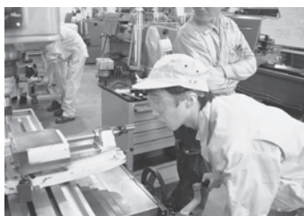
▼機械技術科でフライス盤を使った実習。金属製のさいころを制作する生徒
