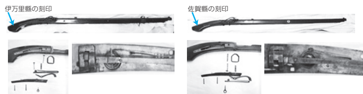
▲内外にあるカラクリの分解(左)と内カラクリのゼンマイ(右)
