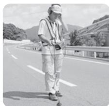
水道管を流れる水の音か、管から漏れる水の音を聞き分けます
