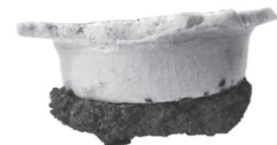
▲焼結土の上に熔着した磁器
